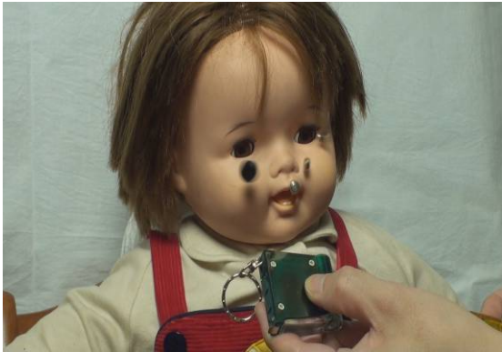
写真5：ボタン電池が当たる様子（正面）
